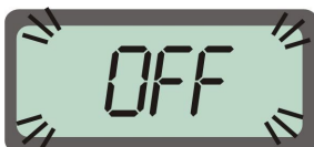
Rysunek 61. Podczas przewietrzania dodatkowego toru gazowego na wyświetlaczu pojawia się na przemian wskazanie OFF oraz ostatnio zmierzona wartość.
