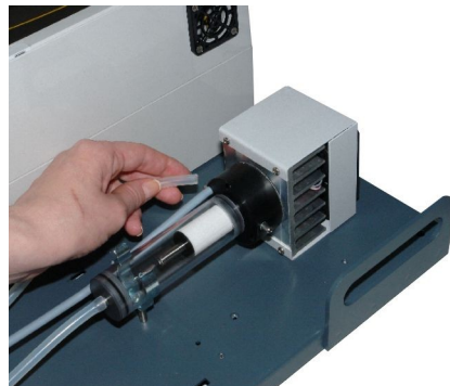
Odłączyć przewód odprowadzający gaz z suszarki do analizatora
