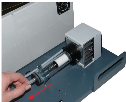
Odłączyć przewód odprowadzający kondensat z suszarki
