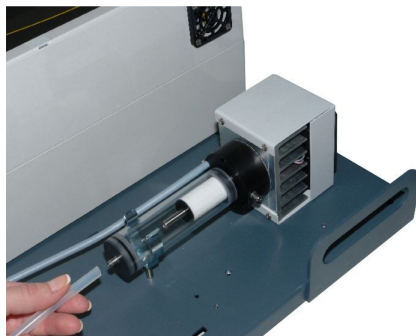
Odłączyć przewód odprowadzający kondensat z suszarki
