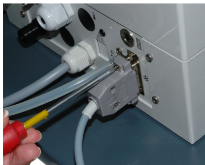
Odłączyć przewód elektryczny łączący suszarkę z analizatorem
