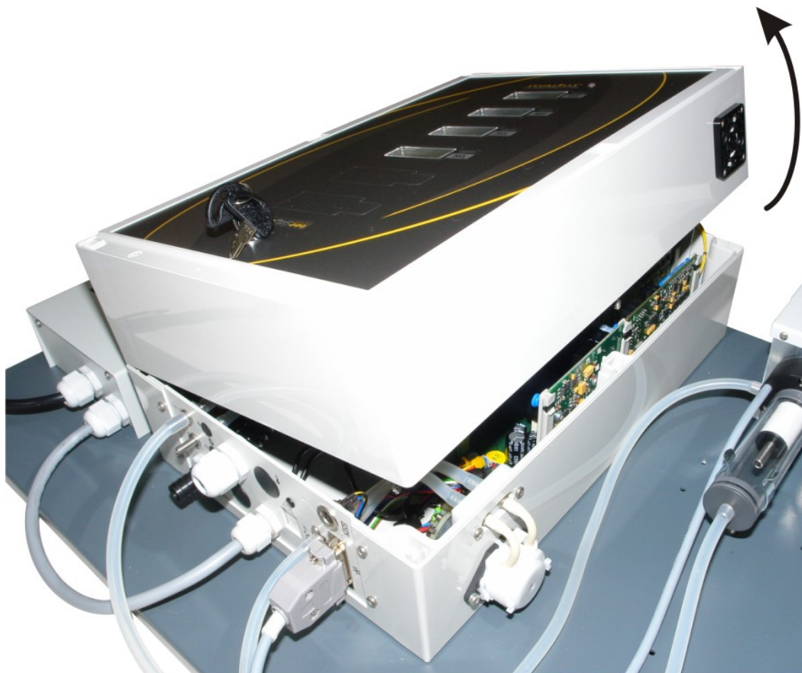
Rysunek 21. Kierunek otwierania górnej pokrywy analizatora mamos
