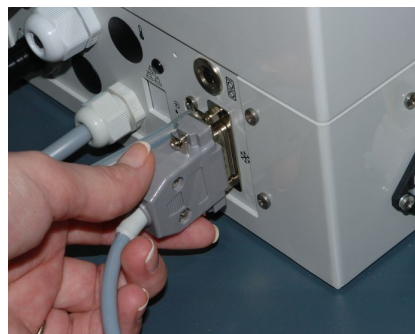
Odłączyć przewód elektryczny łączący suszarkę z analizatorem
